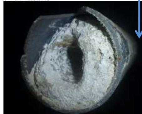
En libérant progressivement des microorganismes épurateurs les blocs de bionettoyant, empêche la cristallisation des sels d'urée totalement insolubles. L'obstruction nécessite le remplacement couteux des tuyauteries d'évacuation
