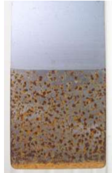
Plaque d'acier traitée par moitié
